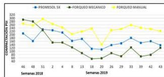
Fig 4. Gráfica de curvas de tiempo y compactación de suelo a 9" de profundidad comparando Promesol 5x y forqueo mecánico y manual. Guayaquil, ECUADOR. (3 aplicaciones 20 L ha<sup>-1</sup> en semana 46 del 2018 y 10 L ha<sup>-1</sup> en semanas 18 y 48 del 2019)
