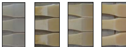
a) PP 03H82 b) Almidón c) 70/30 d)Mater Bi Fig. 4 Contraste después de un mes de exposición en cámara UV-A
